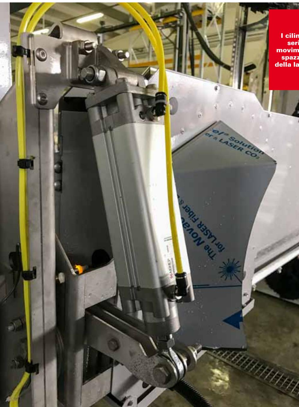
**I cilindri AIGNEP della serie X assicurano movimenti accurati delle spazzole di lavaggio e della lama di asciugatura.**
